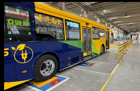
車輛下線檢測設備
